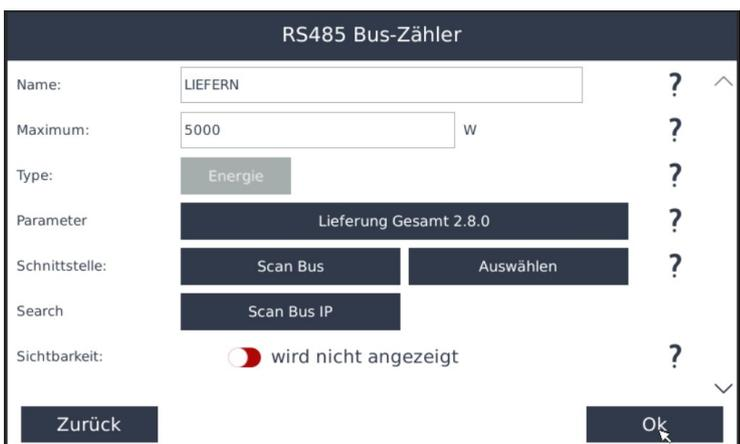
Bei „Schnittstelle“ drücken Sie auf „Scan Bus“. Wählen Sie bei der Auswahl z.B.: „1\_1\_GAVAZZI-EM24DIN“.
